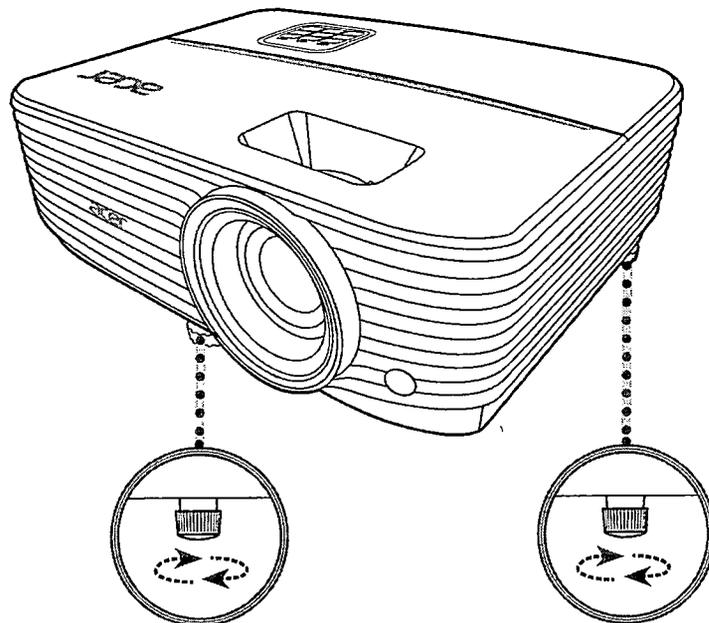
Roda de ajuste da inclinação
